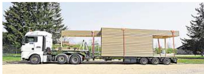
Firmeneigene Sattelschlepper bringen auch solch große Moduleite „just in Time“ und ohne zusätzlichen Koordinierungsaufwand an die Baustelle.
